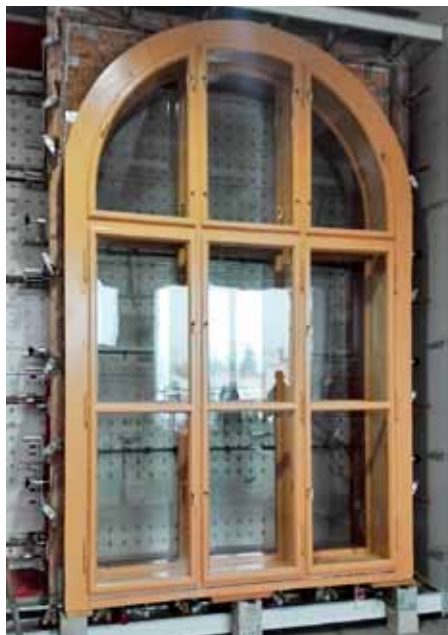
Opravené a upravené původní historické okno modernizovaného historického objektu v zahraniční zkušebně otvorových výplní
