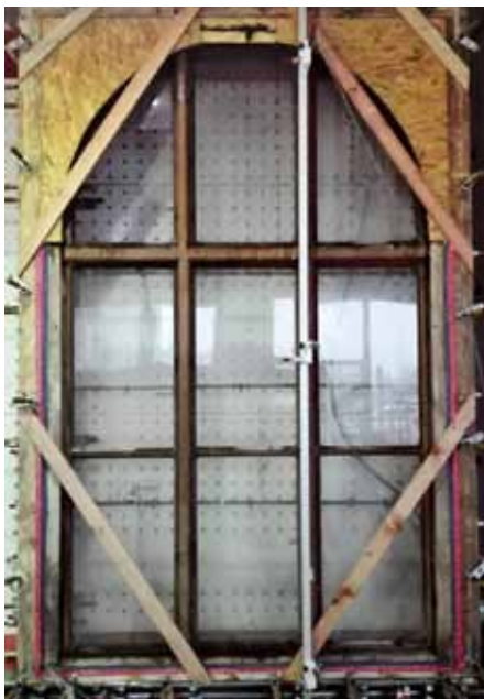
Opravené a upravené původní historické okno modernizovaného historického objektu v zahraniční zkušebně otvorových výplní
