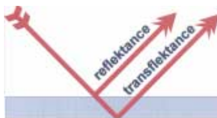
Obr. 3: Rozdíl mezi reflektancí (odrazivostí) a transreflektancí nátěrových systémů
