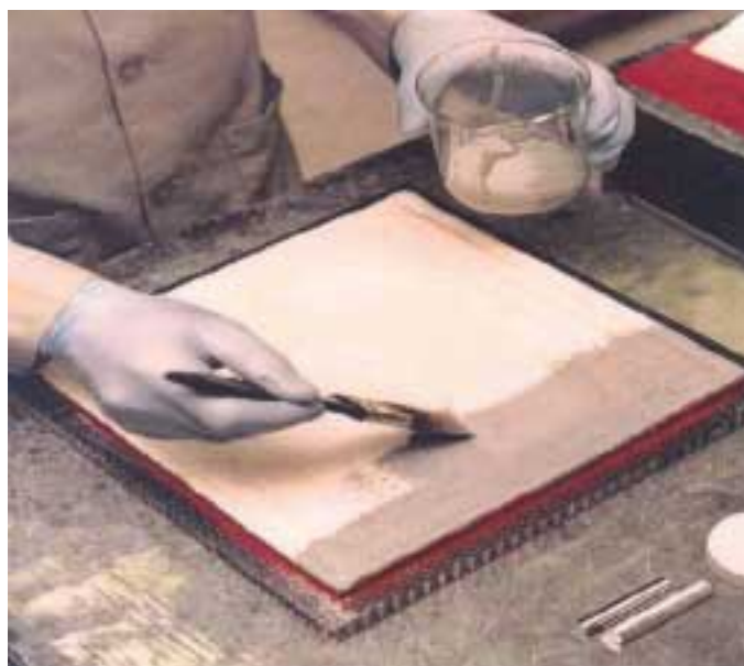
Obr. 1: Ukázka aplikace PCCA nátěrů na keramické dlaždice tvořící obal raketoplánů
