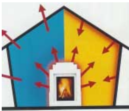
Obr. 2: Princip funkce reflexních nátěrů pro interiérovou aplikaci na povrchy stavebních konstrukcí dle podkladů jejich výrobců. Nátěr „odráží“ tepelné sálání od zdroje tepla umístěného v interiéru
